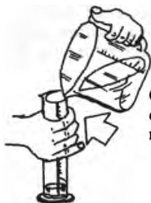
**Colocar suavemente el lactodensímetro dentro de la probeta que contiene la muestra de leche.**
