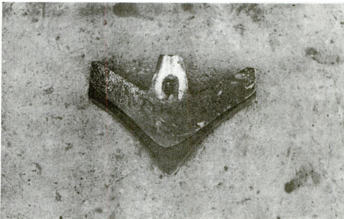
Figura 41. Superposición del escardillo usado sobre el nuevo. Notar el área del escardillo desgastado.
