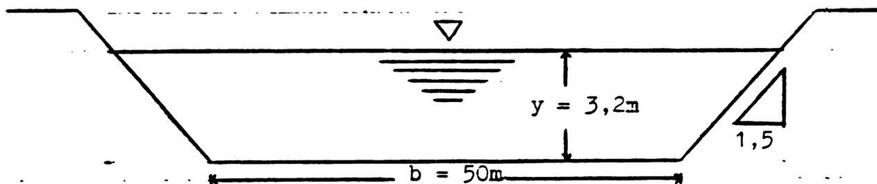
Section transversale d'un chenal trapézoidal pendant un écoulement normal.
