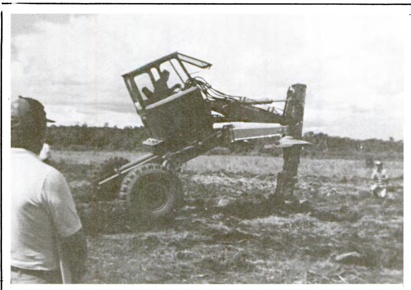
*O sistema hidráulico aciona a cabine e o motor, permitindo evitar o afundamento da máquina e a entrada de água no motor.*
