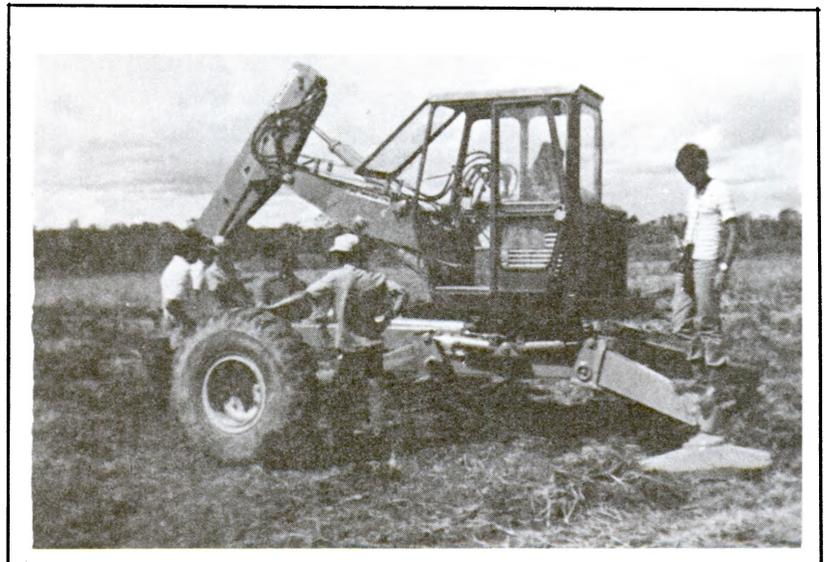
*Demonstração da versatilidade da máquina nos trabalhos. Acima, notar o sistema hidráulico nos pés fixos, nas rodas e na caçamba. Abaixo, a movimentação feita por sistema hidráulico que impulsiona a caçamba no sentido contrário ao dos pneus.*
