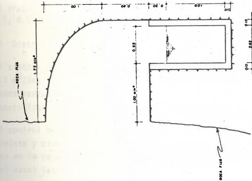
La conducción a las áreas de riego, se efectuará por canales de sección variable, longitud estimada de 36.5 Km. en total, pendiente constante de 0.001 y capacidad variable entre 1.0 m<sup>3</sup>/Seg. y 0.2 m<sup>3</sup>/Seg.
