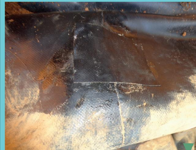
Foto # 26: Orificio arreglado (parchado)
