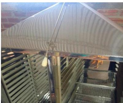
Foto 6. Secadero con aire caliente forzado con temperatura regulable.
