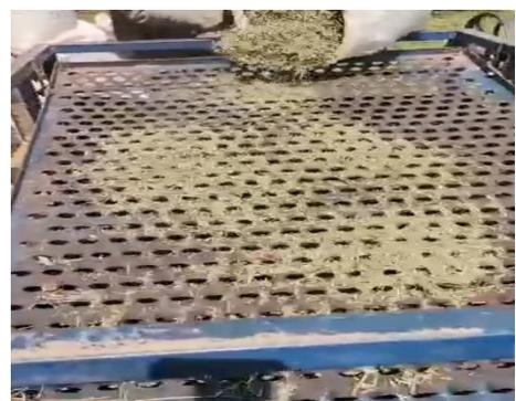
Foto 55. Zaranda vibratoria accionada a motor eléctrica.
