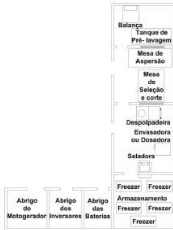
Figura 5-2: Layout de um CCP para beneficiamento de polpa de fruta.
