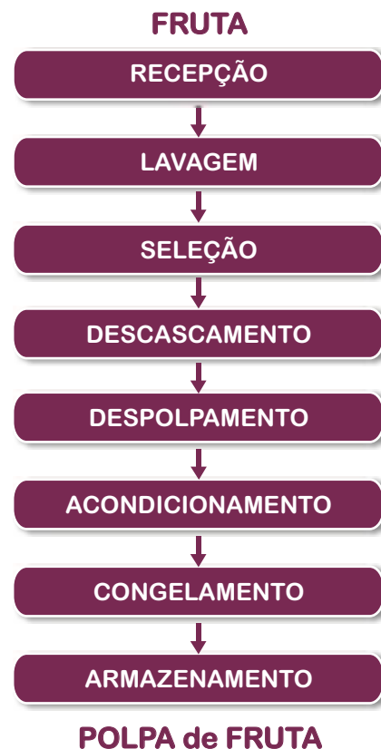
Figura 3-1 Fluxograma do processo de beneficiamento de polpas de frutas e armazenamento a frio.
