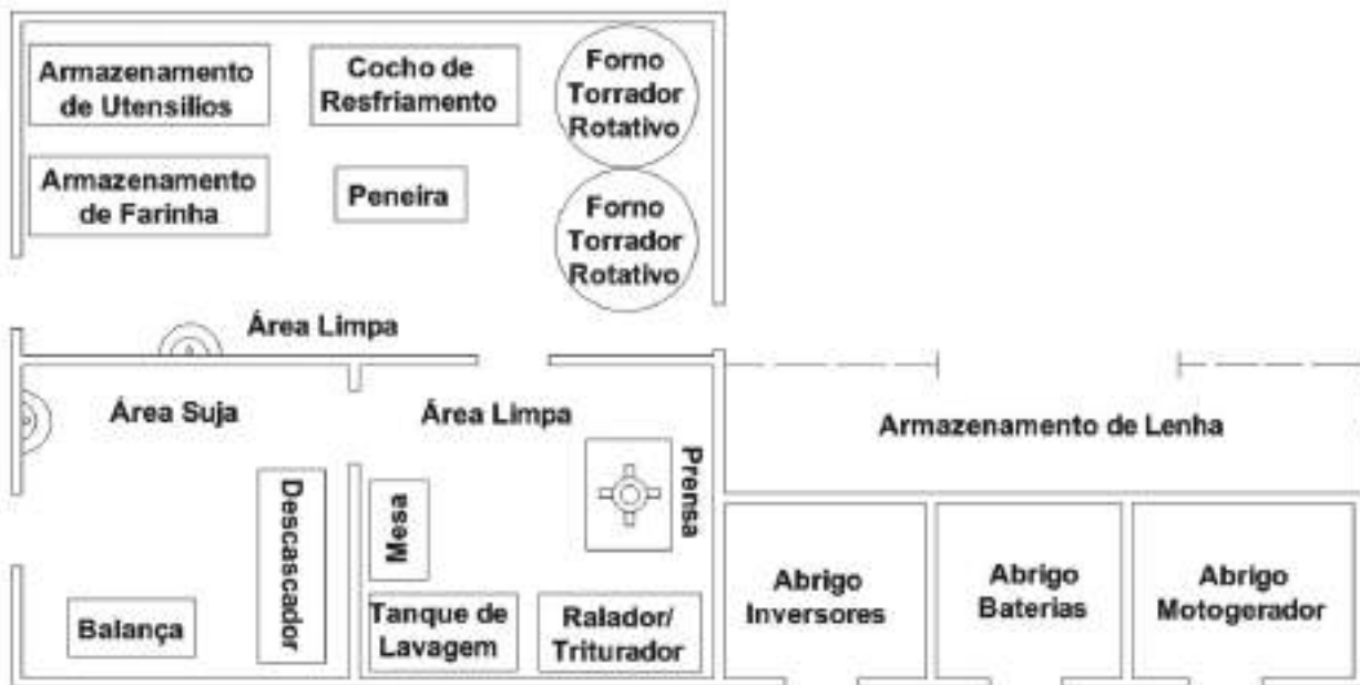
Figura 5-3: Layout de um CCP para beneficiamento de farinha de mandioca.
