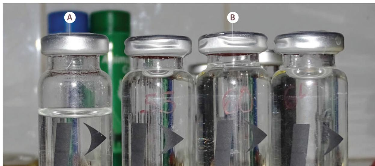
**Figura N° 16.** Formas de tapa de aluminio tras diferentes intensidades de crimpado.
