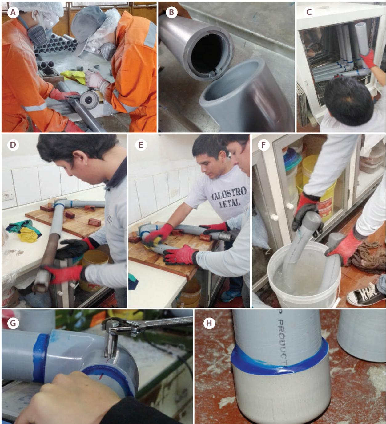
Figura N° 7. Proceso de construcción de *canister* en forma de "V".
