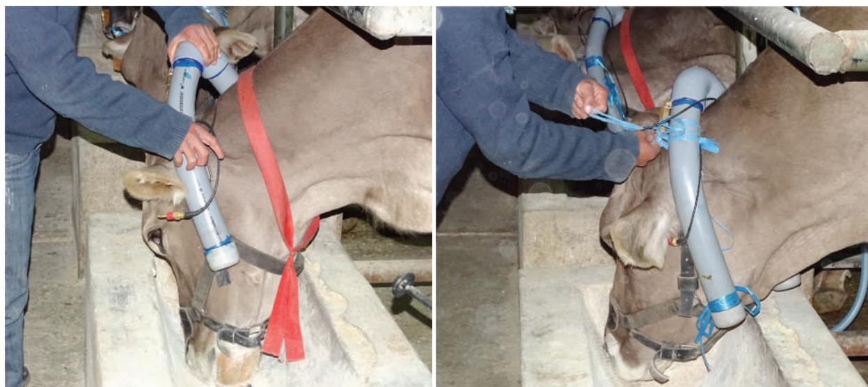
Figura N° 19. Colocación y ajuste de *canister* y línea de muestreo en el animal.
