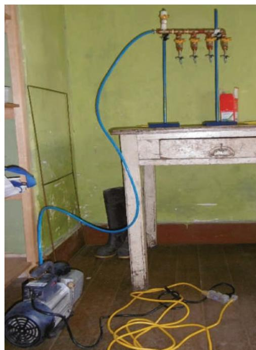
**Figura N° 14.** Sistema de vacío de viales. Bomba de vacío conectada a la tubería con válvulas para el vacío de viales.
