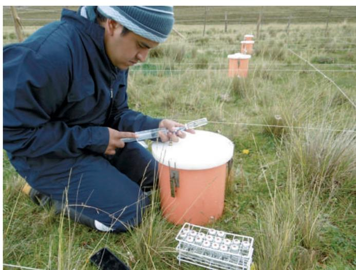
**Figura N° 26.** Toma de muestras de óxido nitroso en viales, procedente del gas recolectado en la cámara estática.
