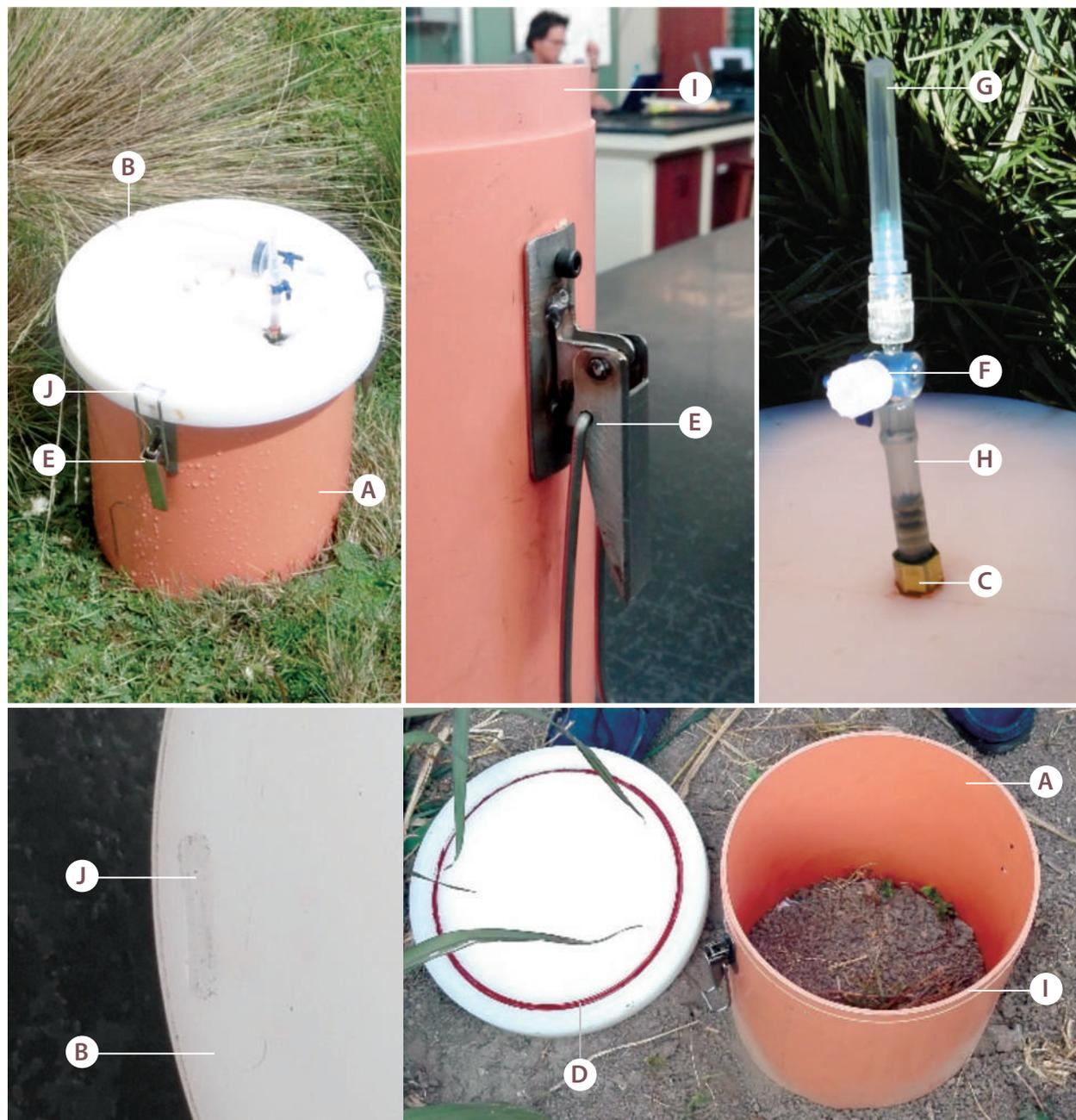
**Figura N° 23.** Elementos de la cámara estática para la colección de muestras de óxido nítrico.
