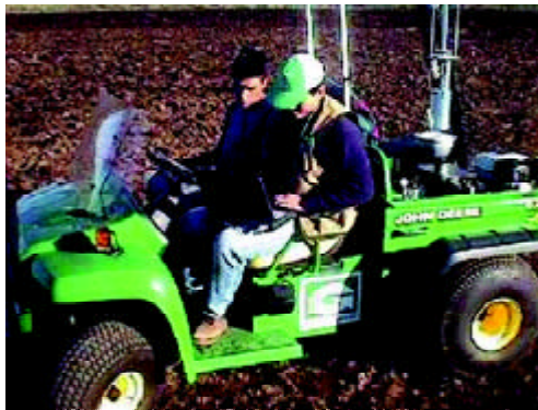
Figura 2.12: Toma de muestras de suelo, georeferenciadas con GPS Diferencial.
