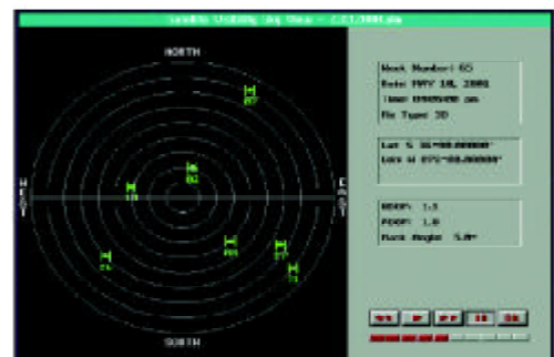
Figura 2.22: Configuración de los satélites para una fecha, hora y posición determinada.
