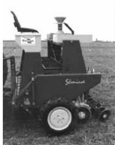
Figura 2.35. Sembradora para siembra directa de parcelas experimentales - SEMINA II - versión trigo
