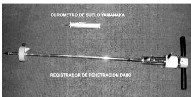
Figura 2.12. Penetrómetros. Arriba: durómetro de suelo YAMANAKA. Abajo: registrador de penetración DAIKI.
