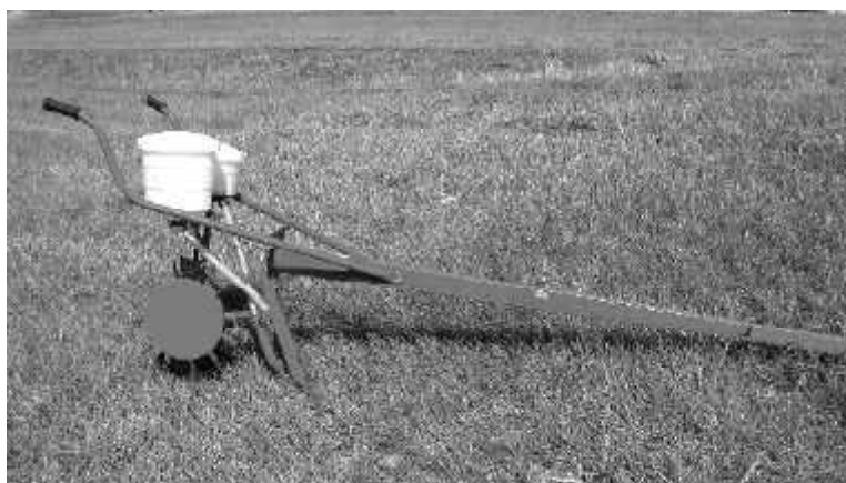
Figura 2.28. Sembradora de tracción animal, para siembra directa, modelo Werner, con chasis tipo arado típico de América Latina.
