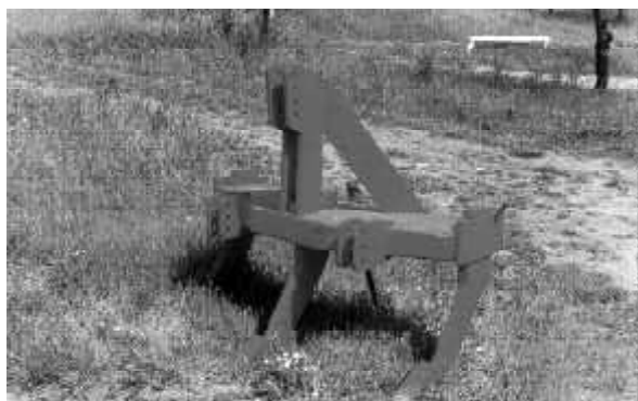
Figura 2.20. Arado subsolador tres brazos de enganche integral al tractor.
