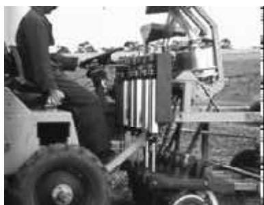
Figura 2.41. Sembradora autopropulsada, modelo "plotman", adaptada
