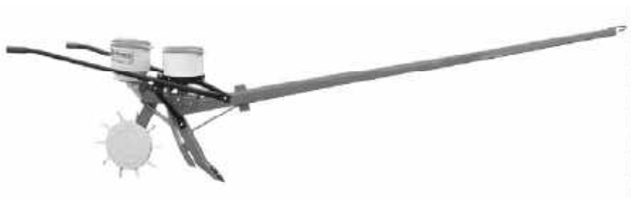
Figura 2.29. Sembradora de tracción animal, para siembra directa, modelo Fitarelli, con chasis tipo arado típico de América Latina.
