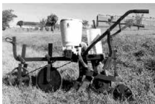
Figura 2.27. Sembradora de tracción animal, para siembra directa, con chasis tipo “arado europeo”.
